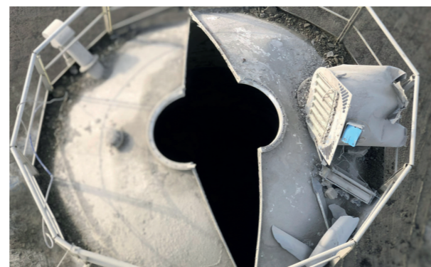
Geëxplodeerd silodak door overdruk
